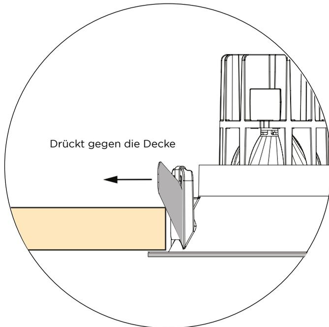
Blattfedern sind vielseitiger als Drahtfedern und können auch in Hohldecken eingesetzt werden, für die man normalerweise Drahtfedern verwendet.
