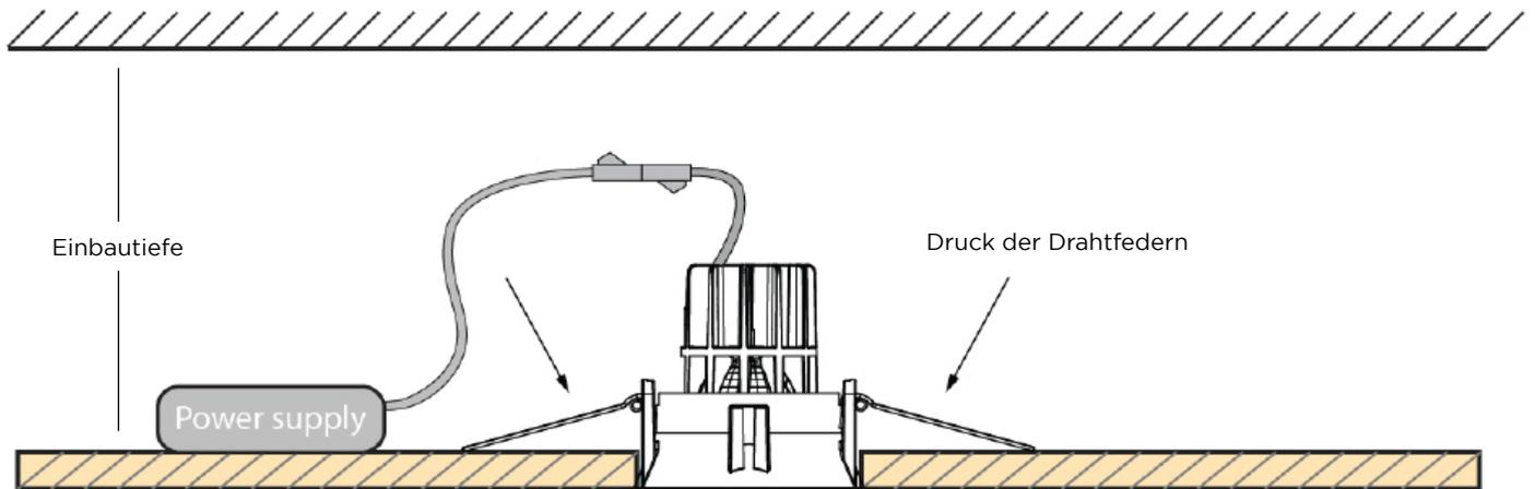
Drahtfedern drücken gegen diese Seite der Decke (oben).
